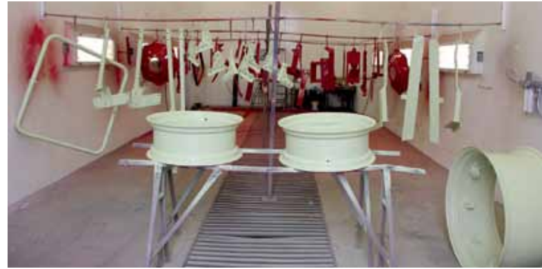
In der Lackiererei werden vor allem Anbauteile instand gesetzt sowie Fahrzeugteillackierungen an Fahrerhaus und/oder Aufbau durchgeführt.
