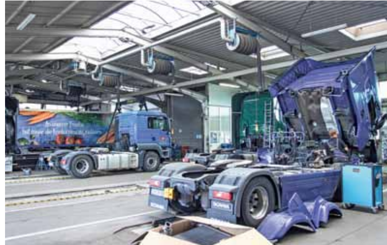
Dank Dachfensterflächen fällt ausreichend Tageslicht in die große Werkstatthalle.
